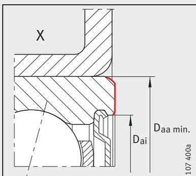
Face d'appui latérale de la bague extérieure
